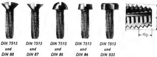
Bild 3. Genormte Schneidschrauben (NSF)
