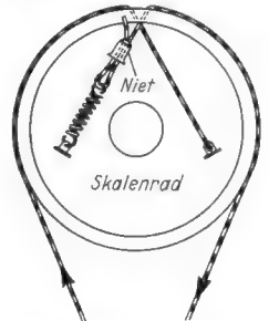
Zum leichten Auflegen eines Skalenseiles wird die Spannfeder nicht mit dem Seil verknüpft, sondern in eine Schlaufe eingehängt, die mit Hilfe eines Hohlriets gebildet wird. Durch Zusammendrücken des Riets läßt sich die Schlaufe festlegen, nachdem die richtige Seillänge eingestellt worden ist
